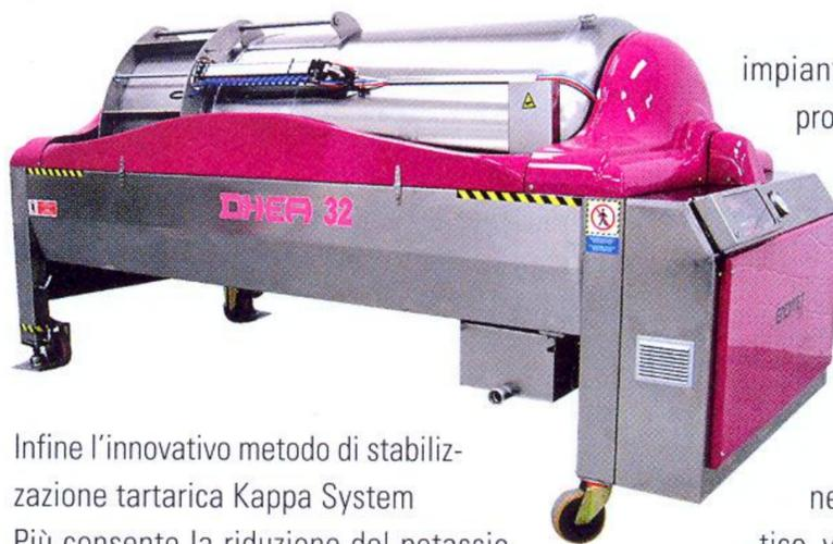
Infine l'innovativo metodo di stabilizzazione tartarica Kappa System Più consente la riduzione del potassio nei vini bianchi e rossi e nei mosti d'uva. Tale tecnica garantisce la perfetta stabilità tartarica senza alterare negativamente le caratteristiche del vino. Il processo è veloce, automatico, non richiede l'impiego di maestranze particolarmente specializzate e non comporta alcun tipo d'incremento o aggiunta di sostanze estranee a quanto normalmente contenuto nel vino.
